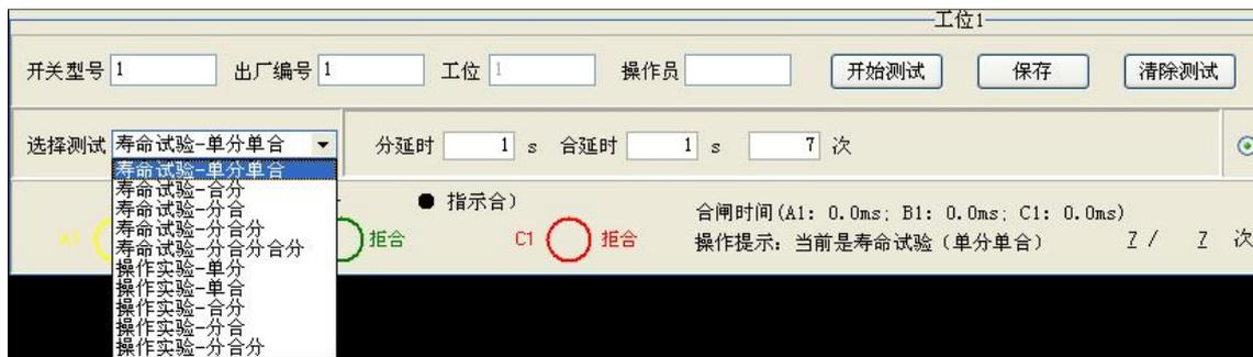
可以看见有十种测试可以选择，总的来说分为两大类，分别为“寿命试验”和“操作实验”，寿命测试实际上是一种循环测试，可以设置循环次数。每种测试的测试参数设置各不相同，参数设置区域位于“选择测试”区域的右边，下面各图是每种测试对应的测试参数：
