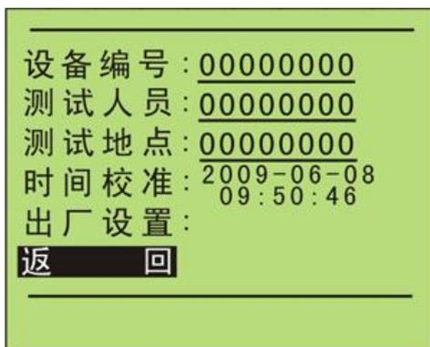
设备编号、测试人员和测试地点由 0,1...9,a,b...z,A,B...Z 任意 8 个组成。在打印时和保存数据时用。
