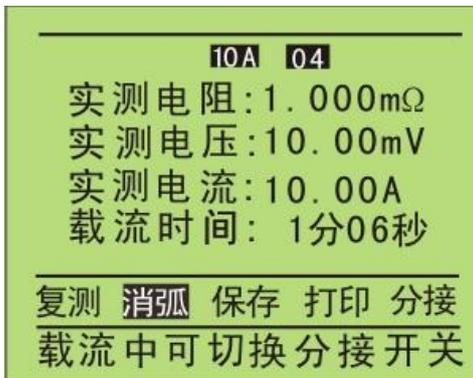
此状态下: 测试电流继续发送。实测电阻显示值是暂停前的测试值。可以用左右键选择消弧退出、复测、保存、打印和分接功能。
