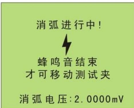
消弧键: 消弧灯亮, 蜂鸣器响, 消弧电压显示由大到小。消弧干净后, 消弧灯灭掉, 蜂鸣器不响, 消弧电压显示为 0, 进入测试结束界面。
