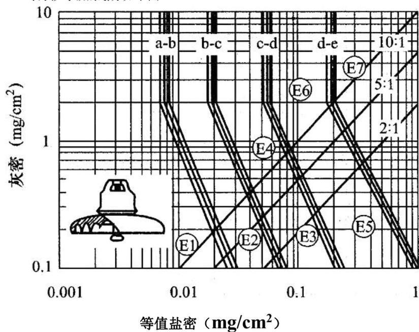
注 1: E1~E7 对应表 1 中的 7 种典型污秽示例, a-b、b-c、c-d、d-e 为各级污区的分界线;
