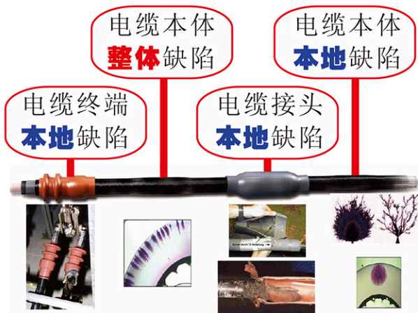
电力电缆终端、接头、本体缺陷 均可用 V34/37/45/62-PD 局放检测、定位
