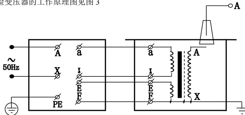
图 3：单台高压试验变压器原理图
