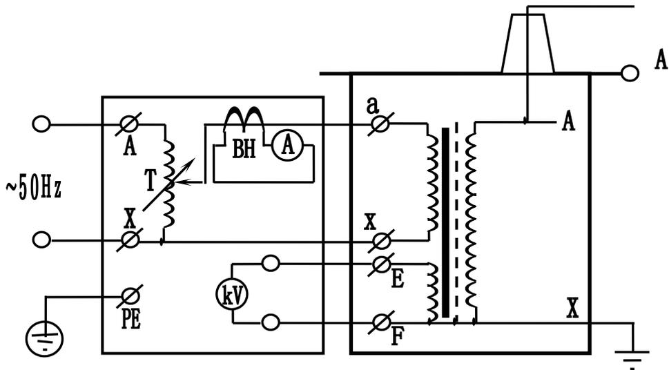
图 1：操作箱（台）工作原理
