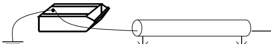
2、接收机连到“*A*”字架上，用适当的力量把“*A*”字架插进土壤中（参见下图）。
