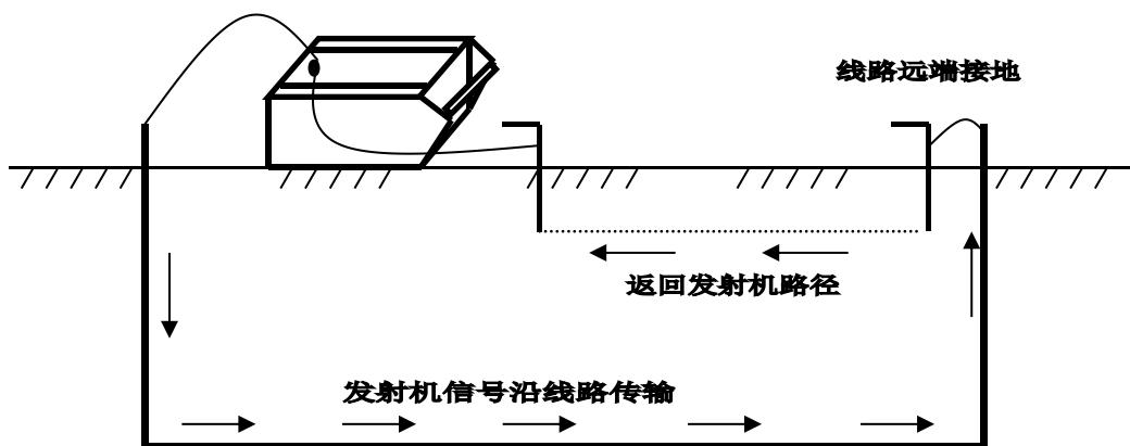
理解“回路”的概念很重要，管线定位仪的所有测试均需要所测地埋电缆线具有良好的回路，若地埋电缆线没有良好的回路就不会产生电流，没有电流就不会有电磁信号产生，没有电磁信号就不会在地面上接收到探测信号，因此就不可能探测到地下电缆。而对于运行电缆一般外铠已接地或零线接地自然形成回路，而对于非运行电缆则需特别注意。
