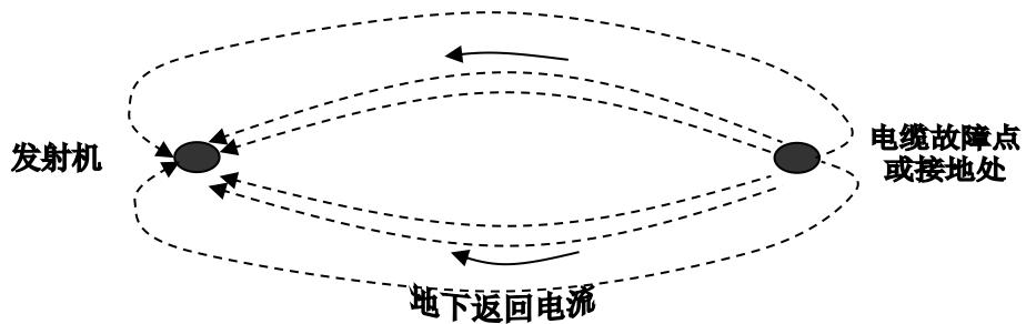
3、接收机可测试流过“A”字架的电流差值。使用“A”字架沿管线行走时，每隔三、四步插入一下“A”字架。开始时可将增益调大，当你逐渐接近故障点（电流高度集中的地域）时，接收信机号的读数会越来越高。这时需要调节增益键以减小接收机的灵敏度。如果信号开始增加，你的行走速度就应适当的放慢；并仔细检查地上的每一小段，以防止忽略故障点。接收机的读数将继续越来越高，直到有一探针跨过这个故障点。当故障点位于两针之间，电流会减小到读数接近零。调节增益键，使得读数保持为适当值，同时移动“A”字架，每次移动10-30厘米，一直到产生一个最低的读数。此时，故障点就位于“A”字架两探针之间（见下图）。
