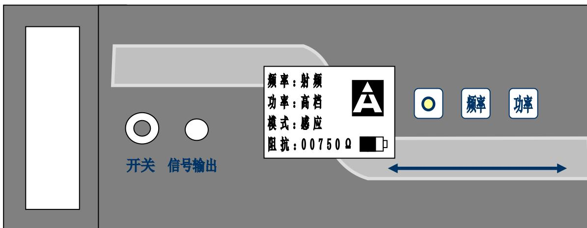
发射机有三个触摸键盘、一个电源开关和一个信号输出口、一个充电器接口和一个液晶显示器。按键、开关和显示屏具体使用描述如下：
