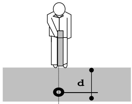
直读测深的方法虽然简单，但要获取正确结果需要一定的条件，否则测量精度不高，甚至得到错误结果。应用直读测深的条件之一是此时的波峰值和波谷测得的路径要基本重合，否则误差会很大。其二是直读的深度要经过校正才能达到较高的可靠性，校正的因素包含：管线埋设土壤的湿度，以及检测信号的频率，一般土壤湿度越大、检测频率越高，校正的系数就应越小，一般在0.8-0.95之间。简单的办
