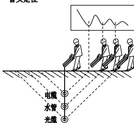
能感应到最浅的或导电性好管线上，在这种情况下用直读法测量时，可能测得深度不可信。
