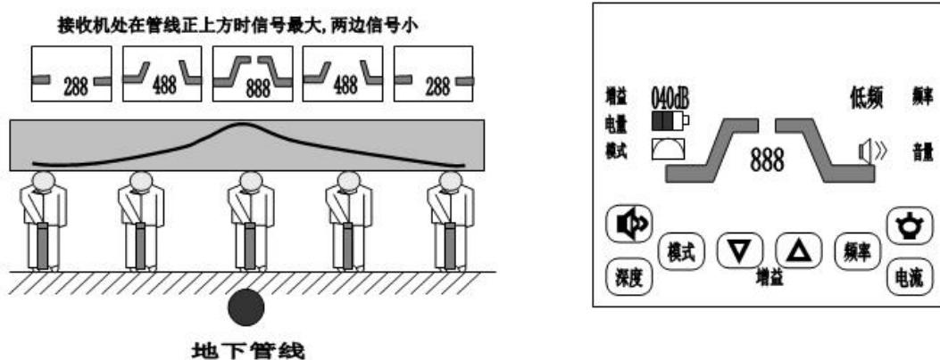
在测试时，峰值的读数可能会随着接收机同发射器之间距离的变大而缓慢减小，这是由于信号延电缆传播中可能有泄漏造成的。调节增益键，可以补偿信号的变化。如果接收机的读数忽然在急剧发生变化，这可能是以下原因造成的：管线连接处（T字接头），此时信号会沿着电缆朝多个方向传播；电缆的埋设深度有变化；电缆外皮受损接地；电缆盘园等。
