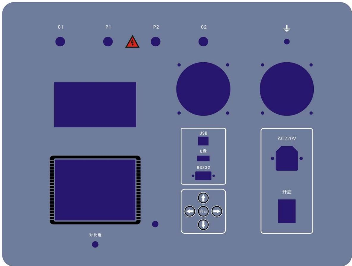
1、C1/C2—电流输出接线柱：C1 连接电流桩，C2 连接接地装置。测量土壤电阻率时，C1、C2 没有极性要求。
