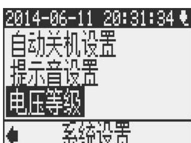
在“系统设置”界面，按【▼】箭头键向下移动光标到“电压等级”子菜单第五项，按【OK】键进入。
