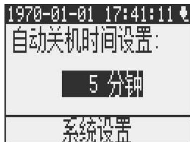
在“系统设置”界面，按【▼】箭头键向下移动光标到“自动关机设置”子菜单第三项，按【OK】键进入。
