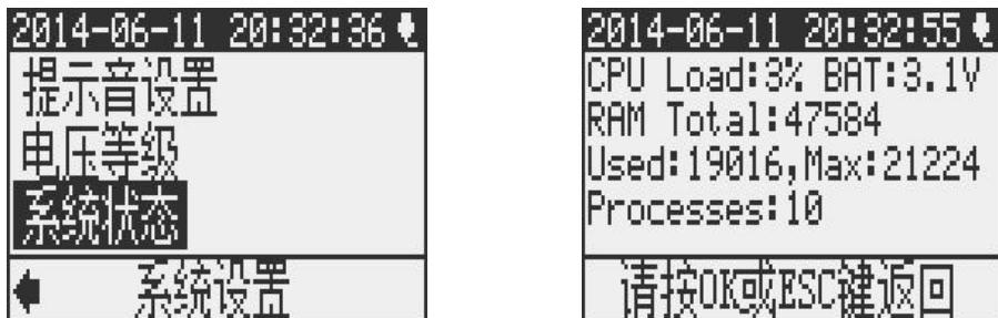
在“系统设置”界面，按【▼】箭头键向下移动光标到“系统状态”子菜单第六项，按【OK】键，显示当前系统的状态，按【OK】或【ESC】键返回“系统设置”界面。
