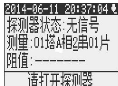
换串设置: 按【◀】【▶】箭头键移动光标到 1 串处, 按【▲】键切换 2 串, 以此类推, 如上图所示。
