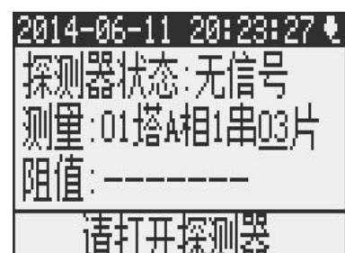
上述设置完成后, 将探测器底部的万向接头与伸缩绝缘杆固定好, 并安装好探测器 A、B 探头, 按下探测器电源开关, 打开探测器, LED 绿灯闪亮。然后将探测器 A、B 探头直接接触被测绝缘子(运行电压中或停电)两端的金具部分, 此时, 按下手持终端上【OK】键, 无线启动探测器测量, 听到“嘟”一声响时, 则该片绝缘子检测完毕, 液晶显示屏会显示“正在测试”、“测试成功”, 即可读取并保存实时测量的 01 片绝缘子的电阻值。仪器自动切换到 02 片、03 片……以此类推, 逐片检测, 如上图所示。若液晶显示屏出现 “>3000MΩ”, 表示所测的绝缘电阻值在 3000MΩ 以上, 是正常绝缘子。
