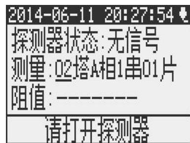
增加杆塔号设置: 按【◀】【▶】箭头键移动光标到 01 塔处, 按【▲】键增加杆塔号 02 塔, 以此类推, 如上图所示。
