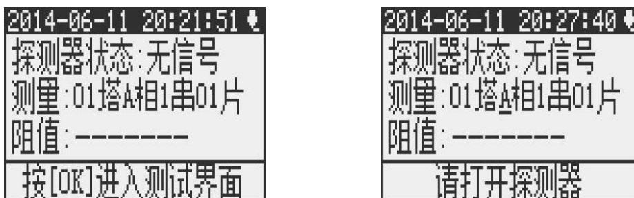
开机进入测试主界面，按【OK】键进入测试界面，按工作票的检测任务，设置一相，检测一相；设置一串，检测一串，如上图所示，设置为 01 塔 A 相 1 串 01 片，按【OK】键开始测试，仪器自动切换到 02 片、03 片……以此类推，逐片检测，完成 A 相 1 串后，按【ESC】键返回，设置 A 相 2 串进入检测，以后各串以此类推。A 相检测完成后，按【ESC】键返回设置 B 相和 C 相，继续对 B 相和 C 相各串进行逐片检测……
